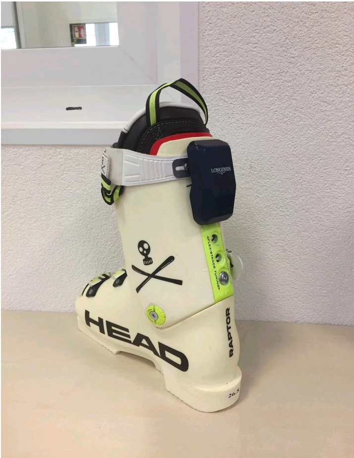
Bild 3: Ski-Schuh mit Elektronik, Radar und Bewegungs-Sensor am Schuhschaft © Peter A. Neukomm
