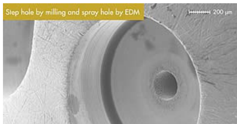
Bild Nr. 2: Gefräste und Micro-Erodierte Bohrung © Posalux
