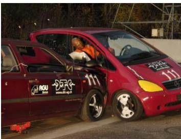
Bild 2: Die Scheiben bersten im Moment des Aufpralls
