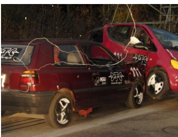
Bild 3: Das stehende Fahrzeug wurde hier schon ca. 2 m verschoben
