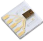
Bild Nr. 6: Planarer Miniatur-Massendurchfluss-Sensor LPG10 für Flüssigkeiten © SENSIRION
