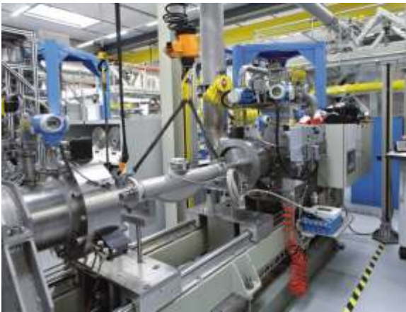
Genaueste (0,015%), akkreditierte Kalibrieranlage der Welt © E+H
