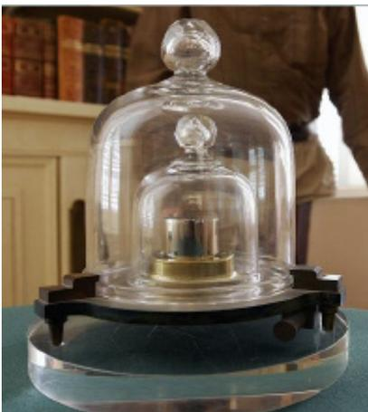
Abb. 3: Geschützte Aufbewahrung des Kilogrammprototyps © METAS
