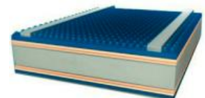
Bild 1: Aufbau einer Hochleistung MB Heterojunctionsolarzelle © Meyer Burger Technolgy AB
