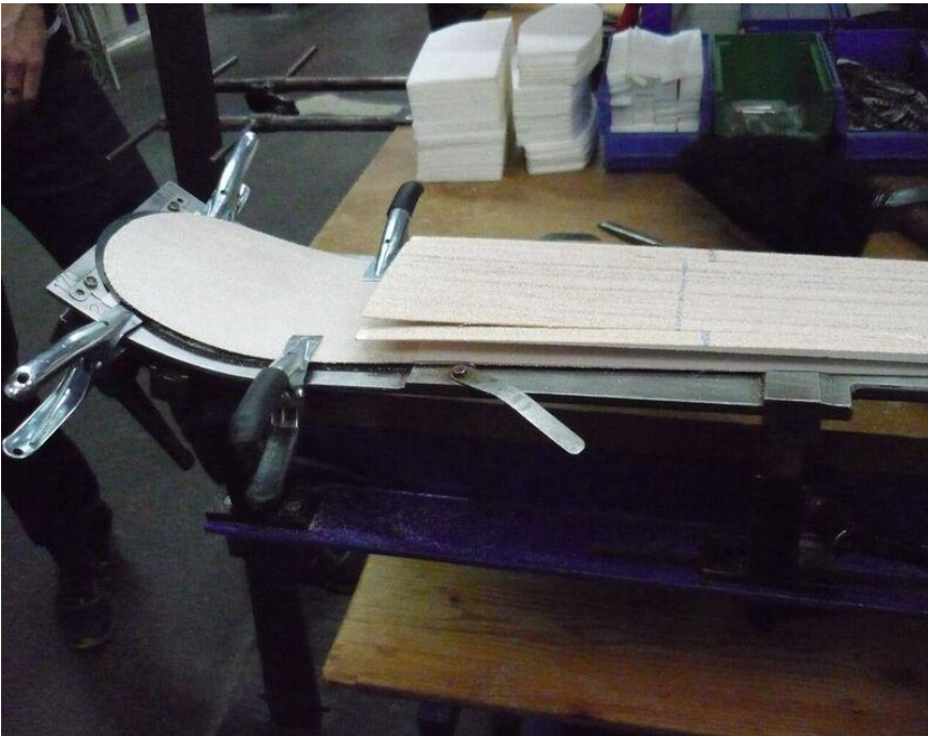
Bild 4: Schon sind mehrere Lagen zum Verpressen aufgeschichtet © Robert Brunner
