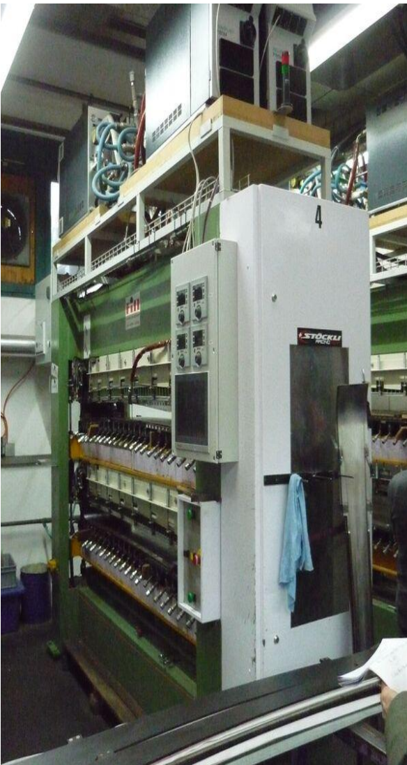
Bild 6: Die Presse, in welcher die Lagen unter hohem Druck und hoher Temperatur verpresst werden © Robert Brunner
