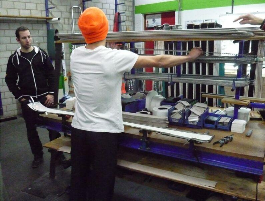
Bild 3: Ein Ski wird zum Verpressen Lage für Lage zusammengestellt © Robert Brunner
